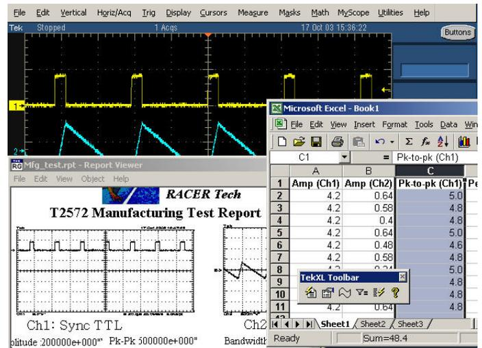
Платформа OpenChoice. Захват данных в Microsoft Excel с помощью Excel Toolbar и создание специального отчета с помощью генератора отчетов Tektronix.
