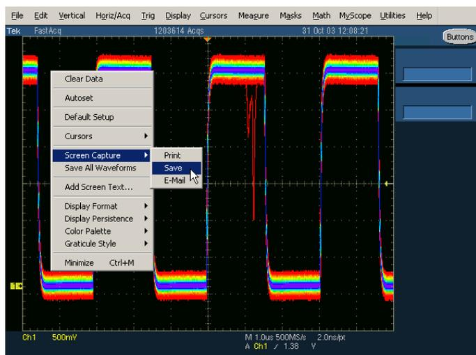
Высокая скорость захвата осциллограмм, обеспечиваемая патентованной технологией захвата Tektronix DPX, улучшает возможность захвата глитчей и других нечастых событий.
