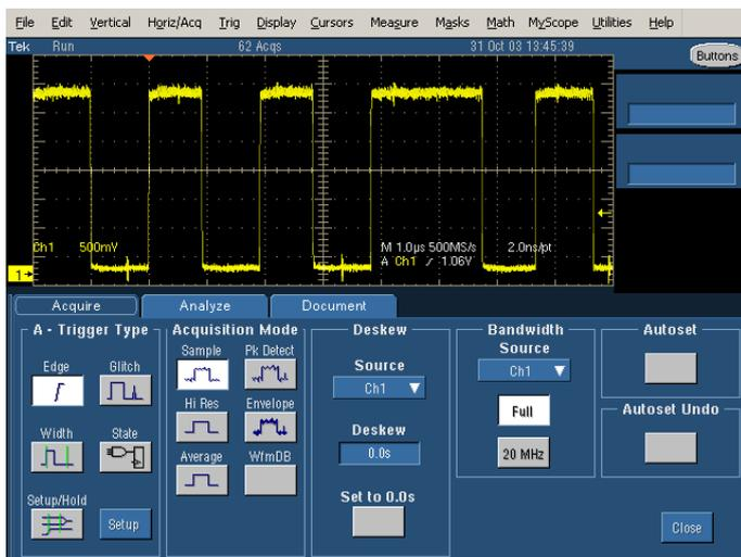
MyScope: После создания они используются так же, как другие окна управления прибора, и могут открываться из меню или с панелей кнопок.
