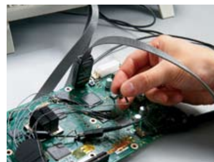
Цифровой пробник P6316 для осциллографов серии MSO2000 упрощает подключение к тестируемому устройству.
