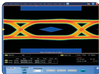
► Глазковая диаграмма проверки в эквивалентном времени на фоне стандартной маски
