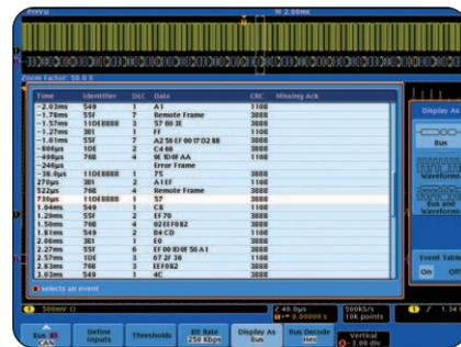
► В таблице декодированных пакетов отображаются декодированные части пакета CAN: идентификатор, управление каналом передачи данных (DLC), данные и контрольный циклический избыточный код (CRC) для каждого пакета в длинной памяти.
