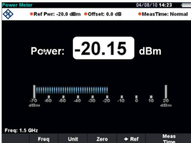
Измерение мощности прямой (выход передачи) и отраженной волны антенны.
