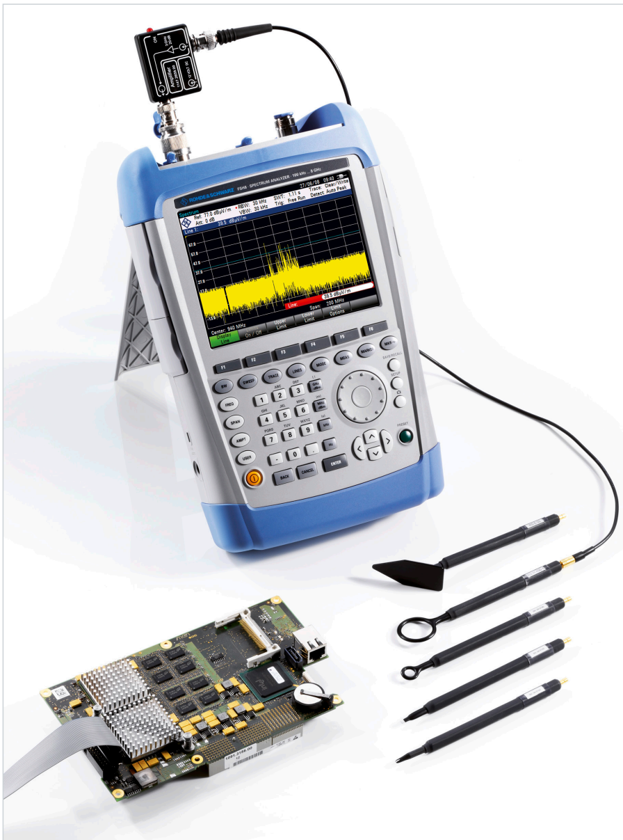
Анализатор спектра R&S®FSH с пробниками ближнего поля и ИУ
