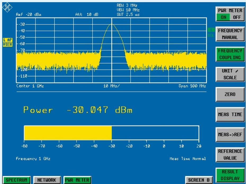
Рис. 1. Измеренная мощность отображается на экране анализатора спектра.
