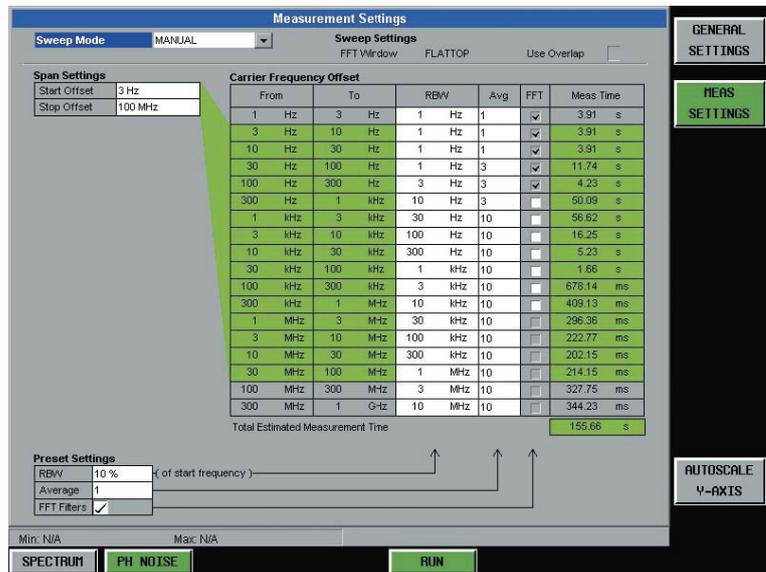
**Рис.2: Установка глобальных параметров для измерений фазового шума:**
