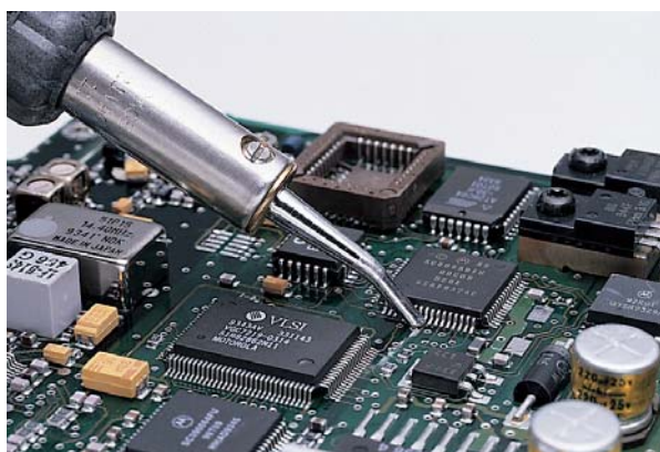
Монтаж SMD - корпусов с помощью наконечника "миниволна"
