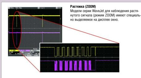
Достаточно нажать кнопку на передней панели для использования функции растяжки, а затем изменить коэффициент растяжки и положение растянутого окна относительно основного с помощью ручек горизонтального управления. Функция растяжки особенно удобна при использовании длинной памяти WaveJet и предлагает наблюдение мельчайших деталей сигнала, которые могут быть пропущены на других осциллографах с короткой памятью.
