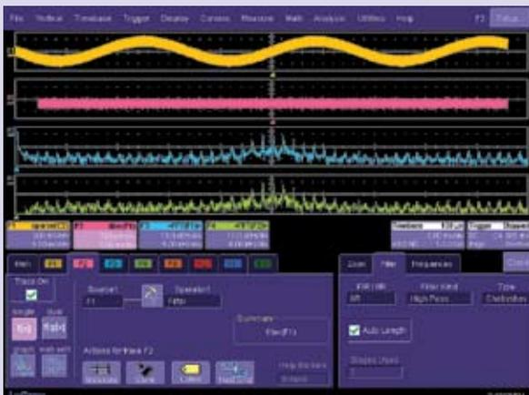
В качестве примера фильтра верхних частот можно взять фильтр для блоков питания (характерная паразитная частота 60 Гц). Частота среза такого фильтра около 1 кГц, диапазон спада частотной характеристики около 1% (очень резкий спад характеристики).
