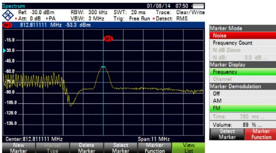
Рис.37 – ЧМ модуляция беспроводного микрофона, работающего в полосе 800 МГц. Меню режима маркера.
