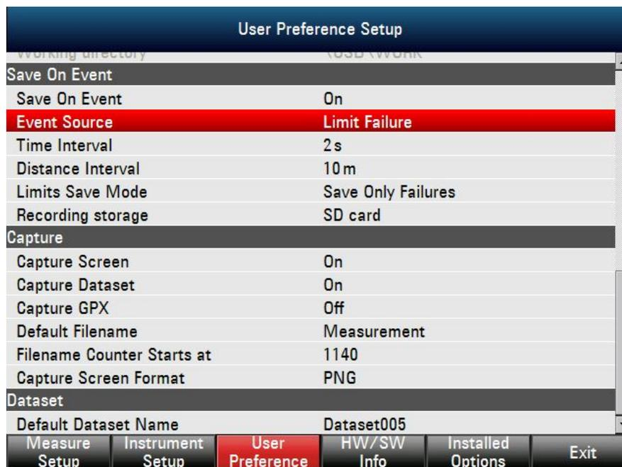
Рис.6 – Функция «Сохранения события» для случая нарушения пределов измерений в меню User Preference Setup
