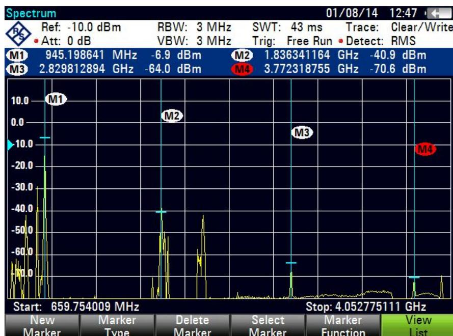
Рис.32 – Гармоники основной частоты на 945 МГц с гармониками на 1,83 ГГц, 2,82 ГГц и 3,77 ГГц
