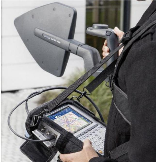
Рис.19 – Измерения с помощью FSH и антенны R&S® HL300 в кобуре для переноски
