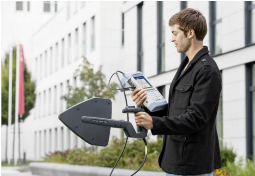
Рис.13 – Локализация источника помех с FSH и направленной антенной R&S®HL300
