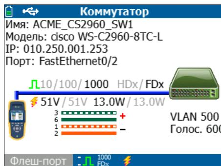
Соединение 100 Мбит/с с PoE на порте 2 по медной линии
