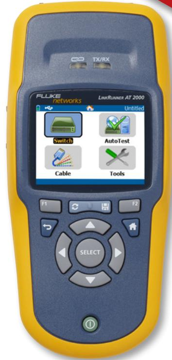
**Тестирование TruePower™ PoE** — быстрая проверка работоспособности PoE посредством доведения фактической мощности до стандарта 802.3at (25,5 Вт). Нагрузка в цепи создает пиковую нагрузку на коммутаторы кабели и коммутационные панели и при этом производятся замеры напряжения и используемых пар. Возможность проверки наличия питания TruePower перед установкой камер, точек доступа и телефонов обеспечивает беспрепятственное развертывание.
