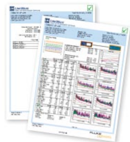
Документирование всех выполненных сетевых тестов в рамках документирования сертификации кабеля, обеспечиваемого ПО LinkWare.
