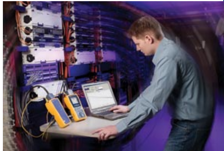
Рис. 3: Парные измерения межкабельных наводок. Основной и удаленный модули прибора подключаются к разным кабельным сегментам на противоположных концах тестируемого кабельного жгута. Чтобы модули прибора работали согласованно, необходимо использовать еще один канал (возможно, в том же пучке) для синхронизации – это позволит провести измерение FEXT по всем сочетаниям пар двух выбранных кабелей.
