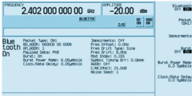
Интерфейс пользователя специализированной программы формирования сигналов Bluetooth для генератора сигналов произвольной формы
