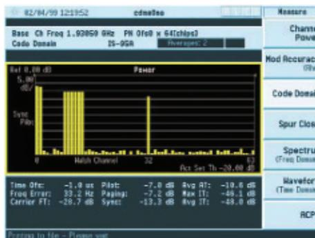
Мощность кодовой области, измеренная тестером передатчиков серии Agilent E4406A VSA
