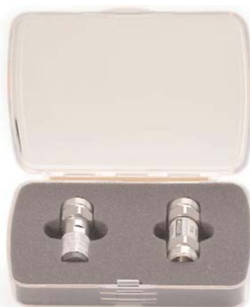
Набор калибровочных мер, рекомендованный для повышения точности при использовании приложения для измерения АЧХ и КСВн (опция N8995A-1FP)
