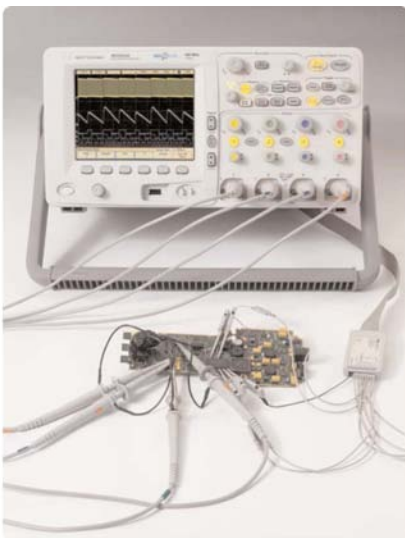
Рисунок 2 - Осциллограф смешанных сигналов (MSO) с 4+16 каналами позволяет одновременно просматривать до 4 аналоговых и 16 логических сигналов
