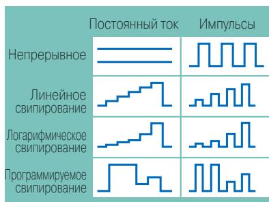
Рис. 2. Различные режимы свипирования R 6243 и R 6244
