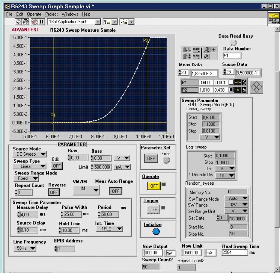
Рис. 8. Пример применения R 6243 с LabView
