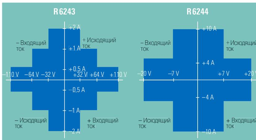
Рис. 3. Выходной диапазон измерительных источников питания R 6243 и R 6244 от Advantest
