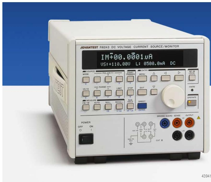
Рис. 1. Двухполюсный источник постоянного тока / Монитор R 6243 оборудован защищенным разъемом (синим), который при измерениях малых токов в нА диапазоне компенсирует ошибки измерения, вызванные внешними паразитными емкостями
