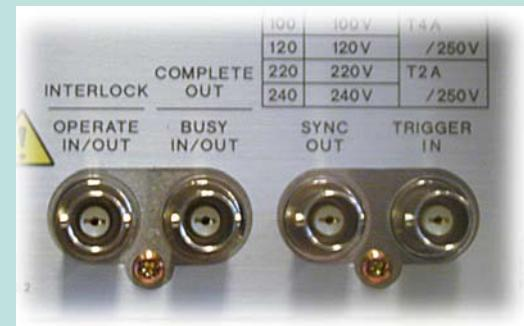
Рис. 7. Универсальность: BNC разъемы на этих источниках тока/напряжения могут иметь несколько назначений и заранее запрограммированы на выполнение различных функций
